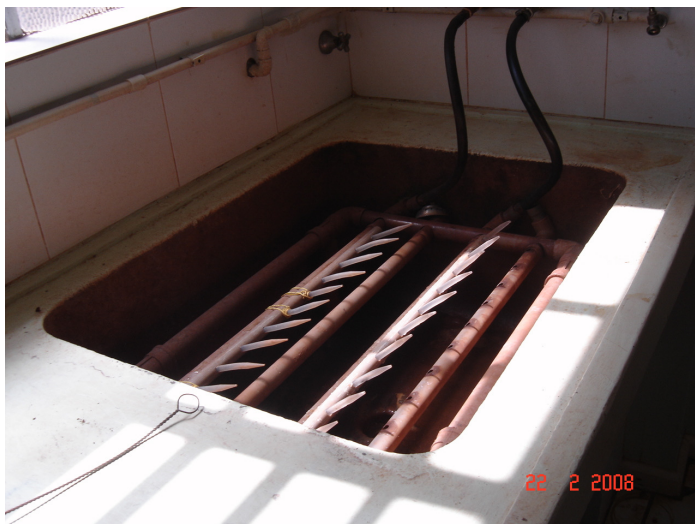
Figura 44: lavadores com bicos para lavagem de recipientes
