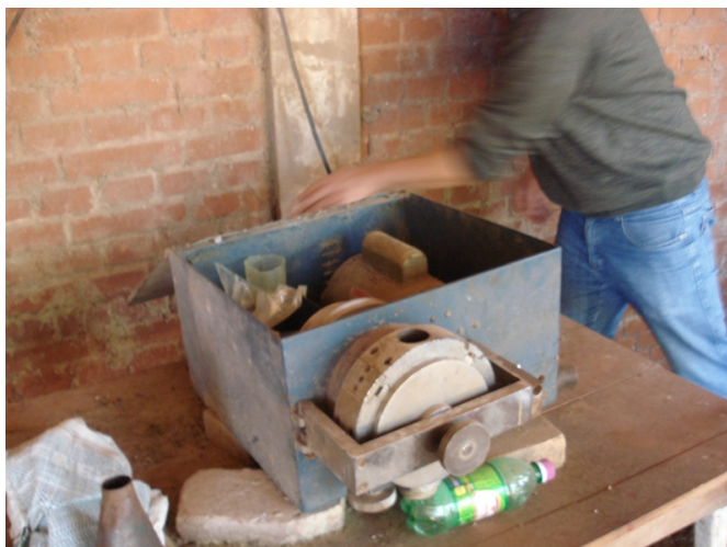
Figura 21: Moedor de solos sem proteção
