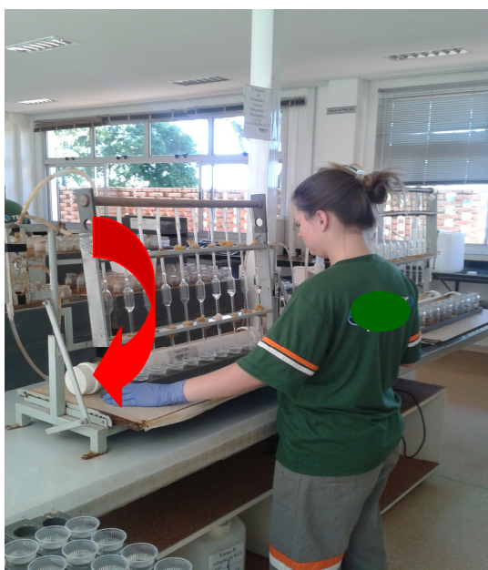
Figura 38: Canaleta elevada através de uma alavanca
